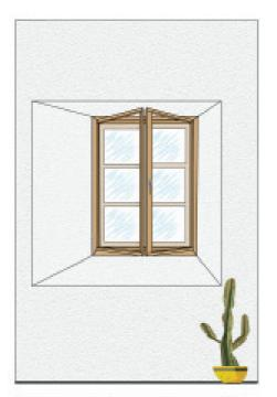
Pri škatlastem oknu vgradimo večslojno (termopan) steklo na notranjih krilih.
