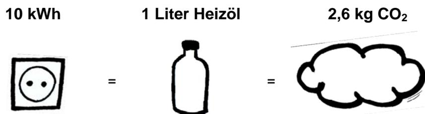
Abbildung 4: Zusammenhang zwischen Energieausbeute und CO<sub>2</sub>-Emissionen bei der Verbrennung von 1 Liter Heizöl
